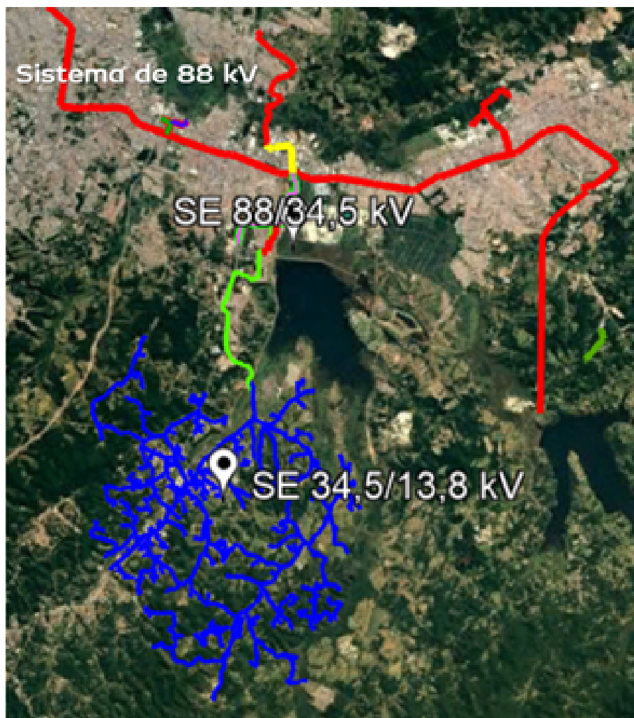
Figura 2. Sistema de Distribuição 34,5 kV existente na EDP com características descritas pela Tabela I.
