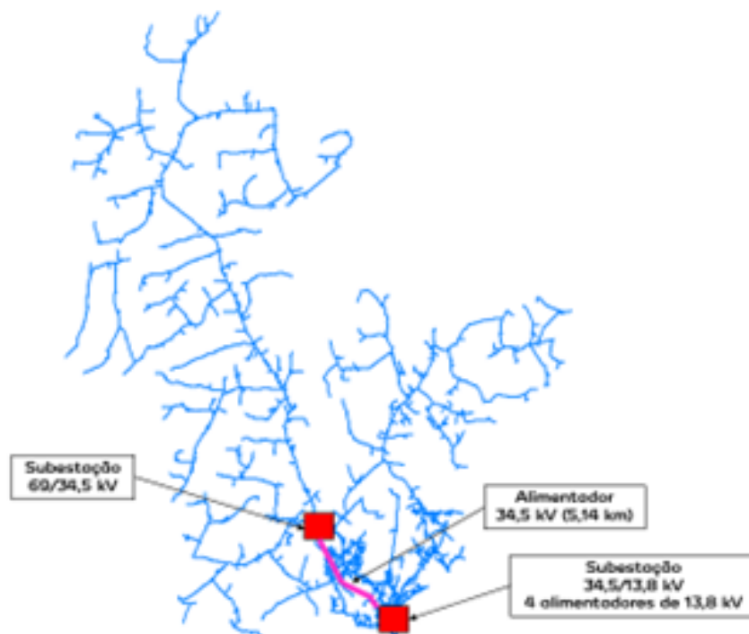
Figura 3. Sistema de 34,5 kV utilizado nas simulações.
